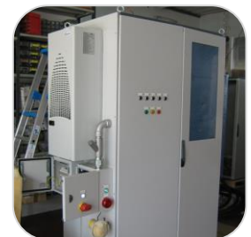
Esempi multipli di calorimetri modelli WI & RBM integrati per zona sicura applicazioni siderurgiche o similari per Sud Africa, India, Malesia...
